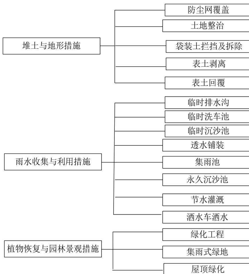
图 3-1 初步设计水土流失防治措施体系框图
