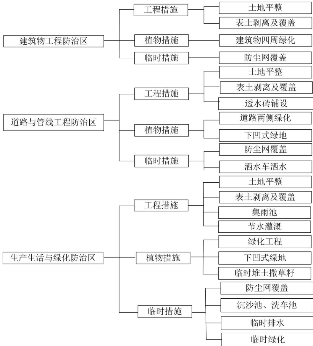
图 3-3 实施的水土流失防治措施体系框图
