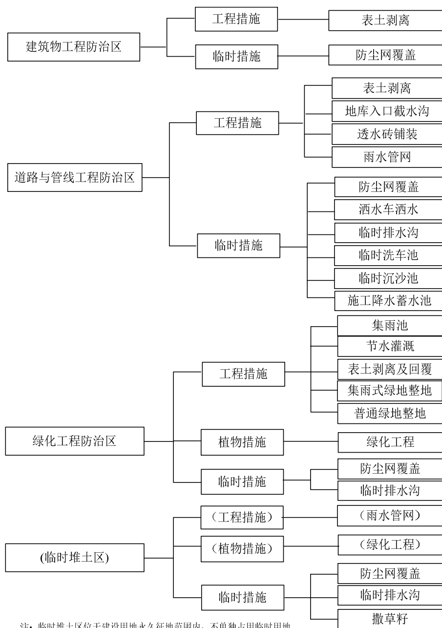
图 3-2 实际实施的水土保持措施体系框图
