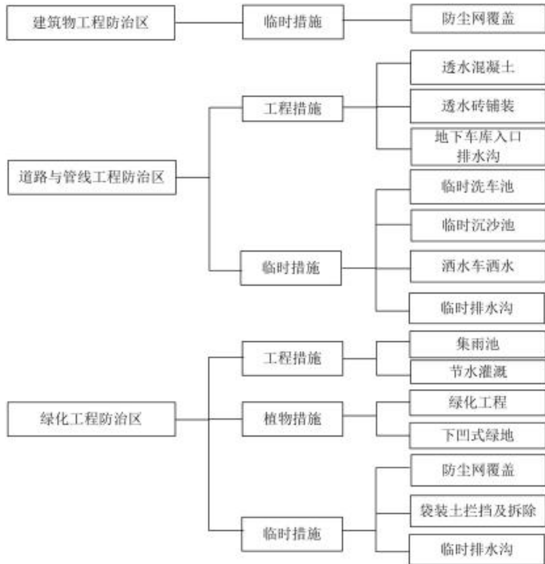
图 3-2 实施的水土流失防治措施体系框图
