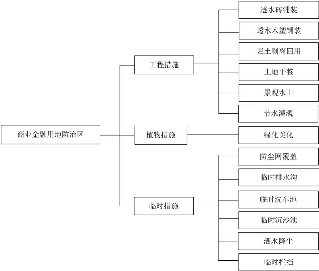
图 3-2 实施的水土流失防治措施体系框图
