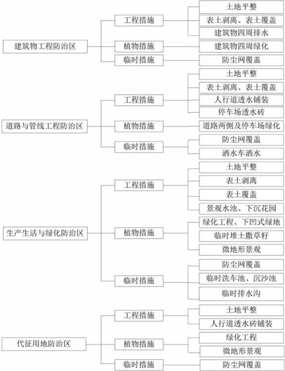
图 3-2 落实的水土流失防治措施体系框图
