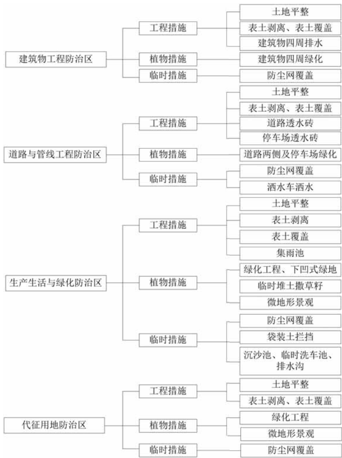
图 3-1 方案设计水土流失防治措施体系框图
